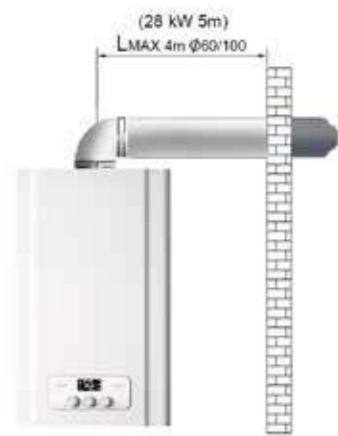
оризонтальная система дымоудаления (Lмакс. расстояние с одним коленом: 4 м, Ø60/100) (Lмакс. расстояние с одним коленом: 6 м, Ø80/125)
